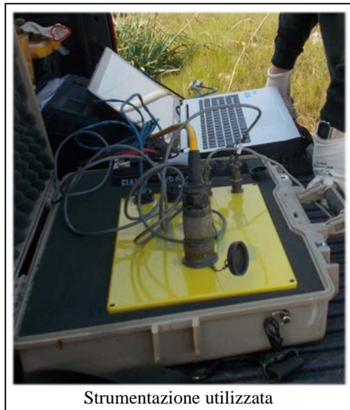
Prima di dare inizio a ciascuna prova si è posta molta attenzione al posizionamento a terra del geofono tridimensionale al fine di ottenere un buon accoppiamento tra pavimento e geofono, avendo cura di livellare e orientare lo stesso verso le direzioni citate.
