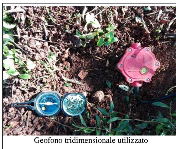
La misura è stata eseguita con una frequenza di campionamento di 500 Hz con tempo di acquisizione compreso tra di 20 minuti.
