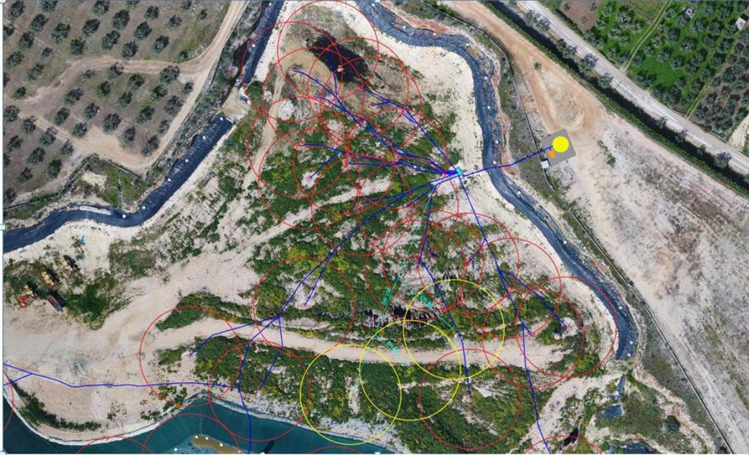
**Figura 6 – Planimetria con ubicazione nuovi pozzi di captazione biogas (in giallo)**
