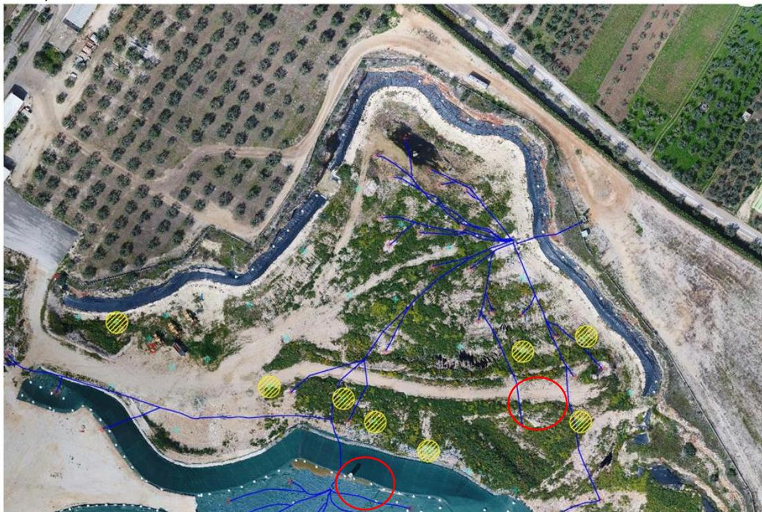
**Figura 5 – Planimetria con ubicazione dei punti emissivi di biogas in giallo, dei punti di monitoraggio biogas in ciano ed in rosso i pozzi di captazione biogas**
