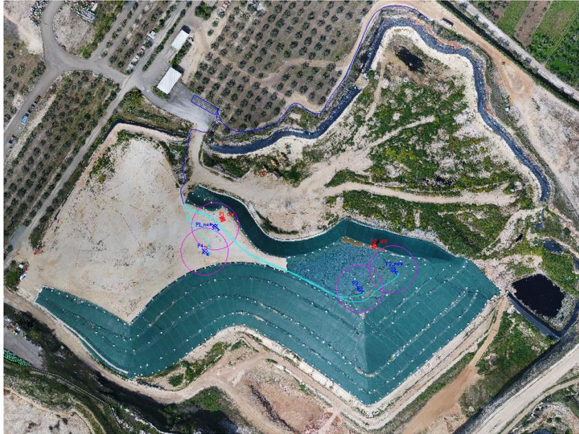
**Figura 12 - localizzazione dei pozzi di emungimento del percolato e raggi di influenza della barriera idraulica realizzata nei Lotti I e II**
