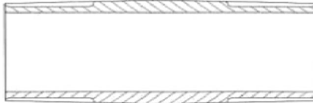
*Figura 8 Nippolo per tubi in acciaio di tipo pesante*
