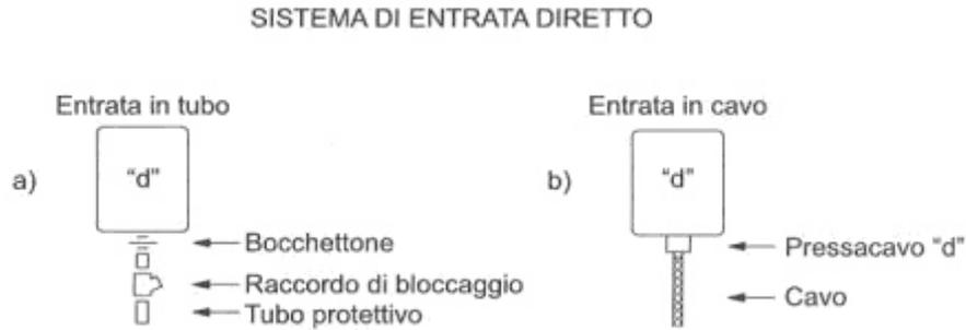
Figura 24 Sistema di entrata diretta della condotta (cavo o tubo) in una costruzione Ex d
