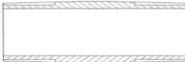
Figura 8 Nipplo per tubi in acciaio di tipo pesante
