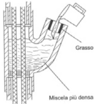
Figura 20 Il primo strato di miscela indurita sul fondo evita il trafileamento della miscela
