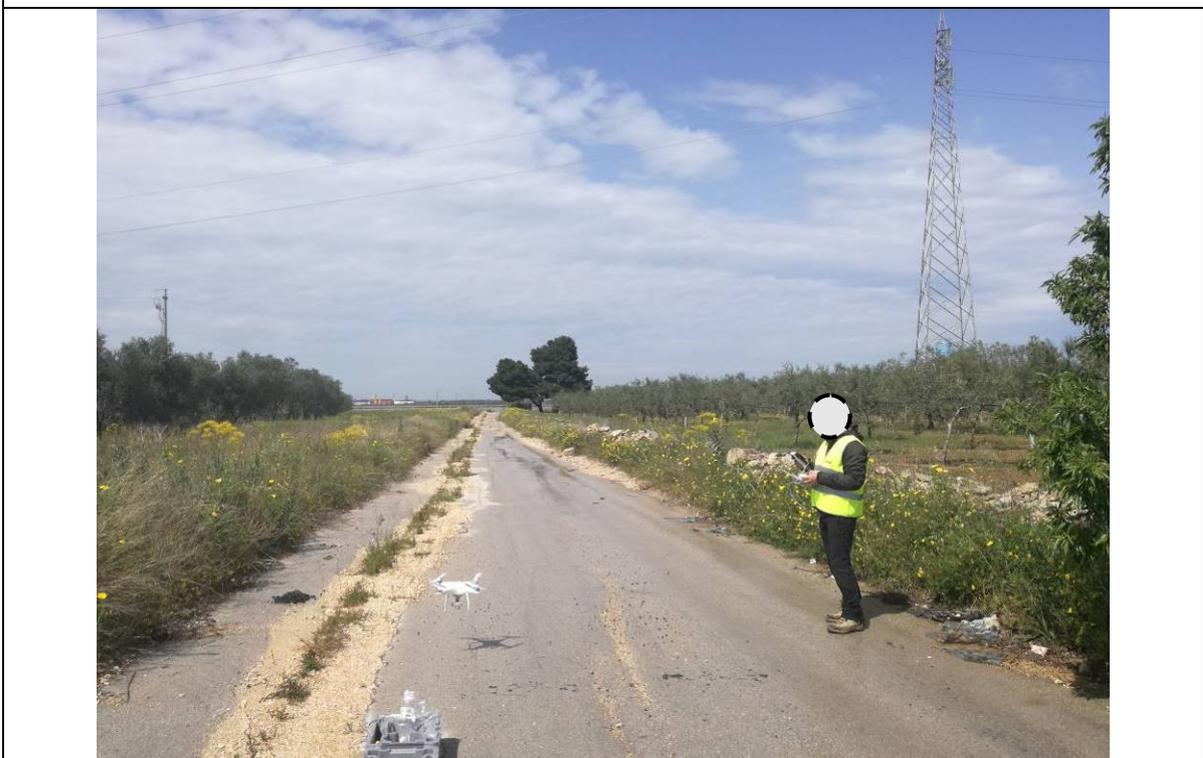
La sovrapposizione delle aree inquadrare di ogni singola foto eseguita è stata dell'80% di sovrapposizione longitudinale - overlap (rispetto alla direzione di volo) e dell'80% di sovrapposizione laterale - overside (tra le strisciate). Le immagini sono state acquisite seguendo una maglia regolare a "zig-zag" procedendo in un'unica direzione. Come mostra lo schema che segue.
