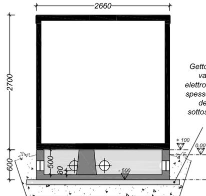
Getto di calcestruzzo dello spessore variabile, (min. cm. 10 con rete elettrosaldata Ø 8 - Maglia 15 x 15). Lo spessore e l'armatura sono in funzione delle caratteristiche del terreno sottostante e spetta alla direzione dei lavori tale determinazione.
