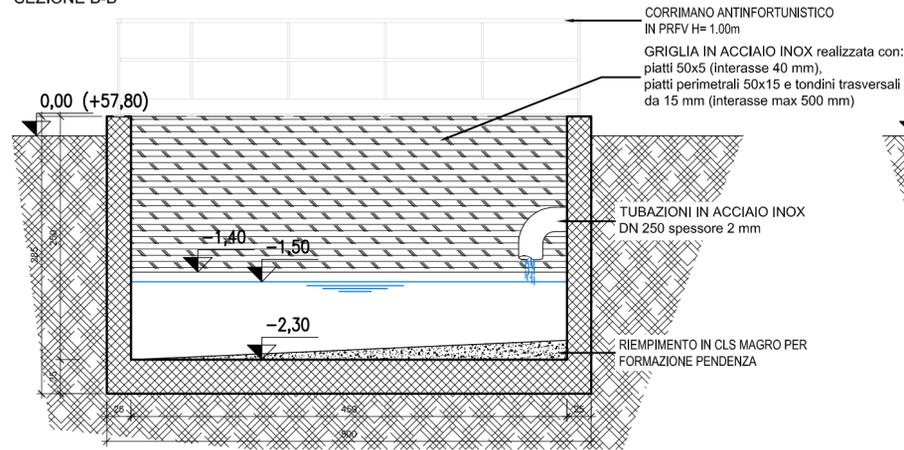
VASCA DI DISCONNESSIONE E TRATTAMENTO - SEZIONE C-C
